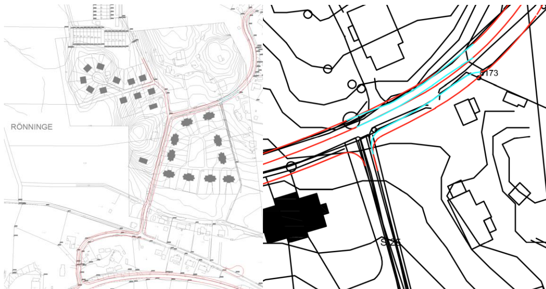
Figur 17. Projekteringsritning över Rönninge Gårds väg. Röda linjer visar huvudförslaget. Ljusblå linjer visar alternativ med avsmalning, ses inzoomad t.hö.
