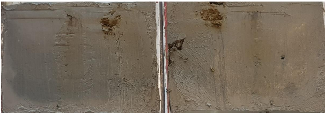
Figur 2 Borrpunkten, 20B24, 3,0 m, Jordprovet i övre delen av mellanhylsan delad longitudinellt provhylsan med id Bjerking 1277.
