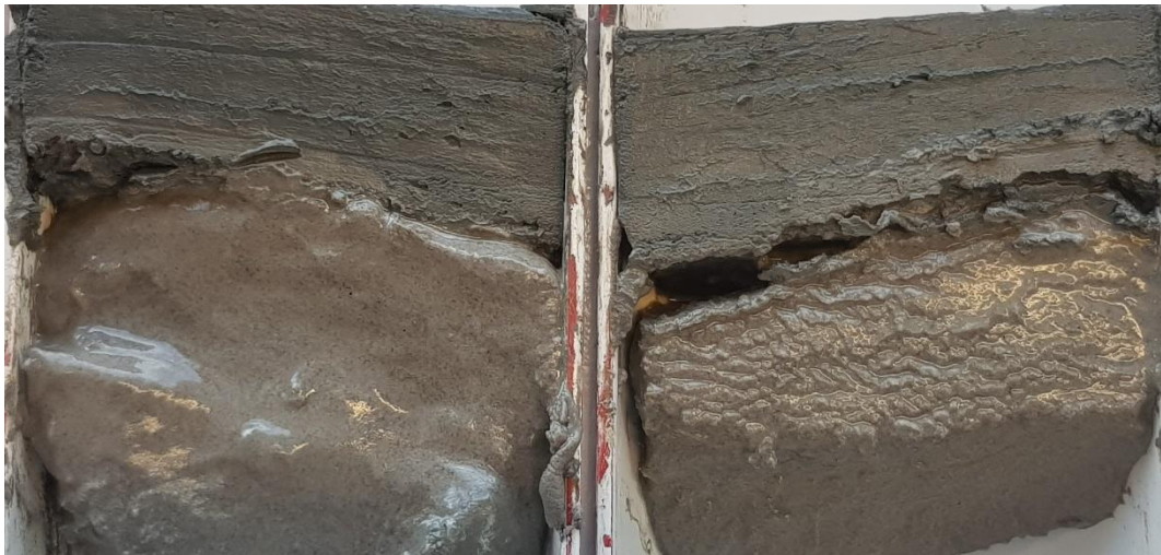
Figur 5 Borrpunkten, 20B26, 5,0 m, Jordprovet i övre delen av mellanhylsan delad longitudinellt provhylsan med id Bjerking S 564.
