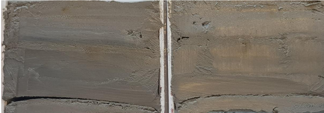
Figur 1 Borrpunkten, 20B09, 3,0 m, Jordprovet i övre delen av mellanhylsan delad longitudinellt provhylsan med id Bjerking 1548.
