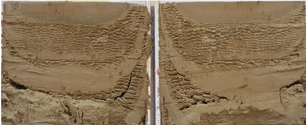
Figur 4 Borrpunkten, 20B26, 2,5 m, Jordprovet i övre delen av mellanhylsan delad longitudinellt provhylsan med id Bjerking 1345.
